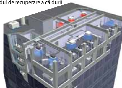
Funcționarea în modul de recuperare a căldurii
